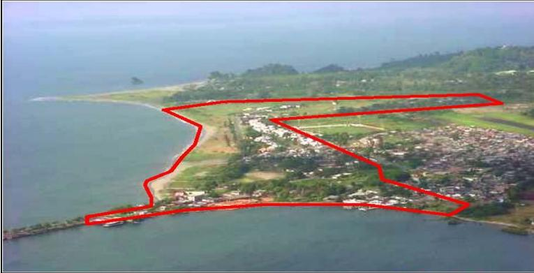
Fotografía de los Sectores 18 y 19 con alto potencial de licuación, sobre rellenos hidráulicos. Fuente: Evaluación de la vulnerabilidad física por terremoto y sus fenómenos asociados en poblaciones del Litoral de Nariño. 2003.
